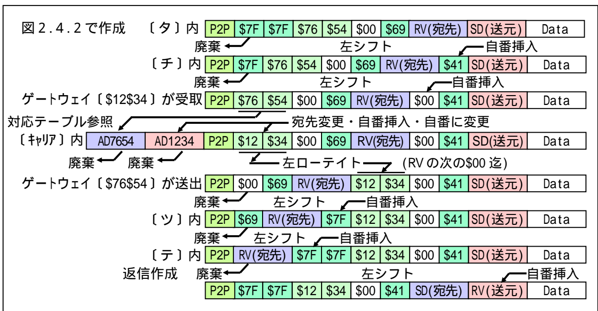
図 2.7.3 コモンキャリアおよび Marsit でのメッセージ変換例
